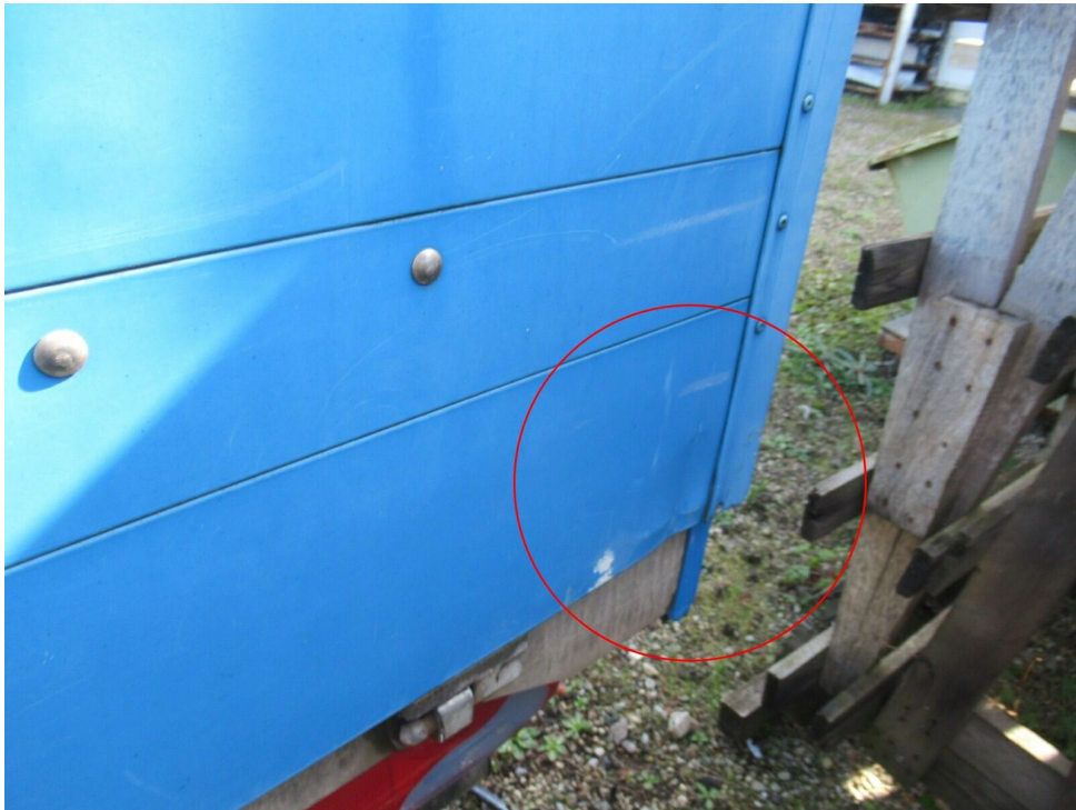
Bild 8 : Bordwände leicht eingedellt / zerkratzt
