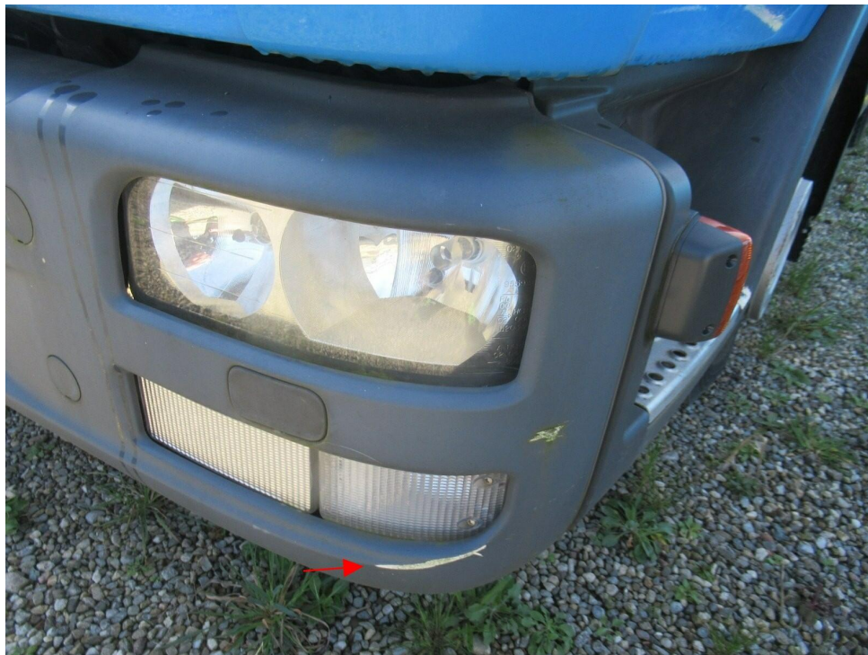
Bild 7 : Stoßfänger vorne verschrammt
